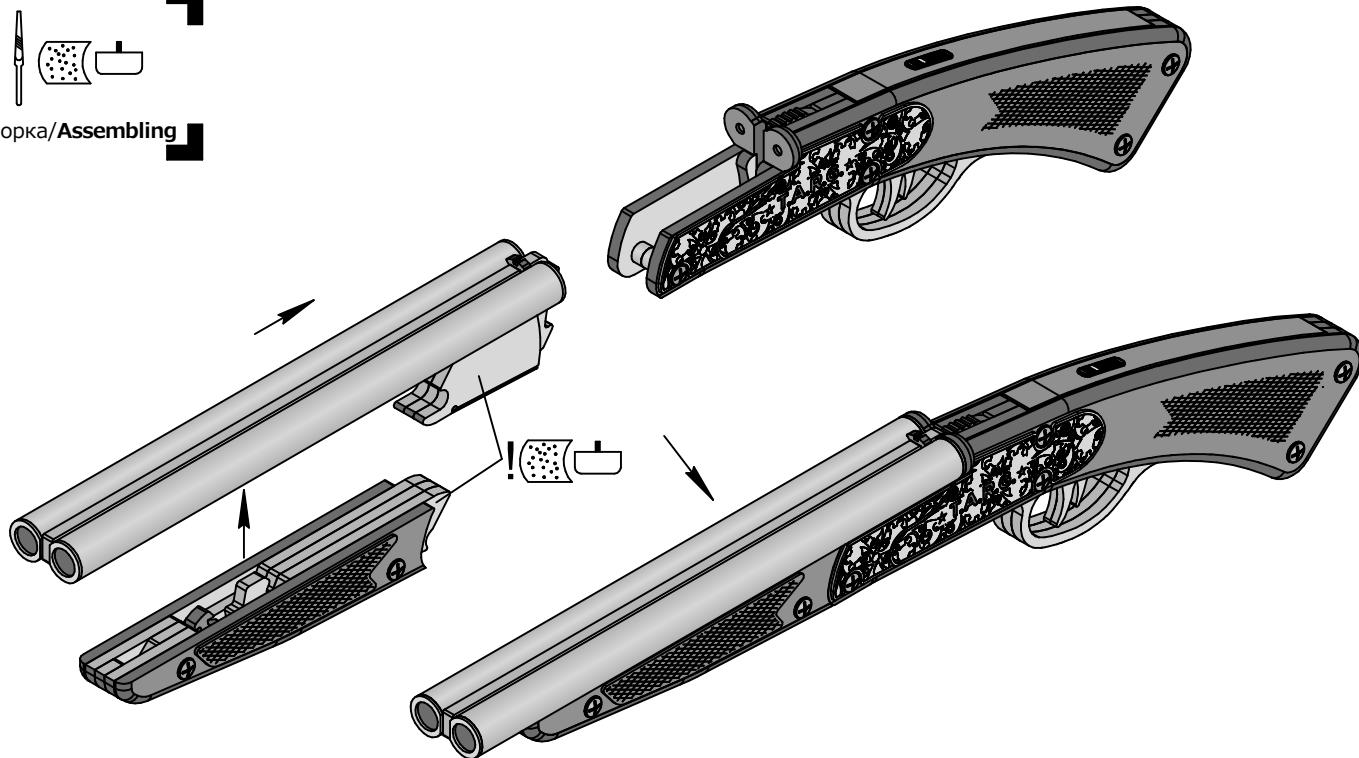
! Перед фишишной сборкой, проверьте легкость соединения деталей. При необходимости немного обработайте указанные места наждачной бумагой. По окончании нанесите парафин для смазки.
