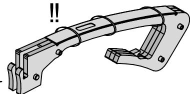
Чтобы выровнять склеиваемые детали, вставьте шкант или стяжку в отверстие. **Следите, чтобы клей не попадал на шкант или стяжку.** После высыхания клея, шкант или стяжка должны легко выниматься.
